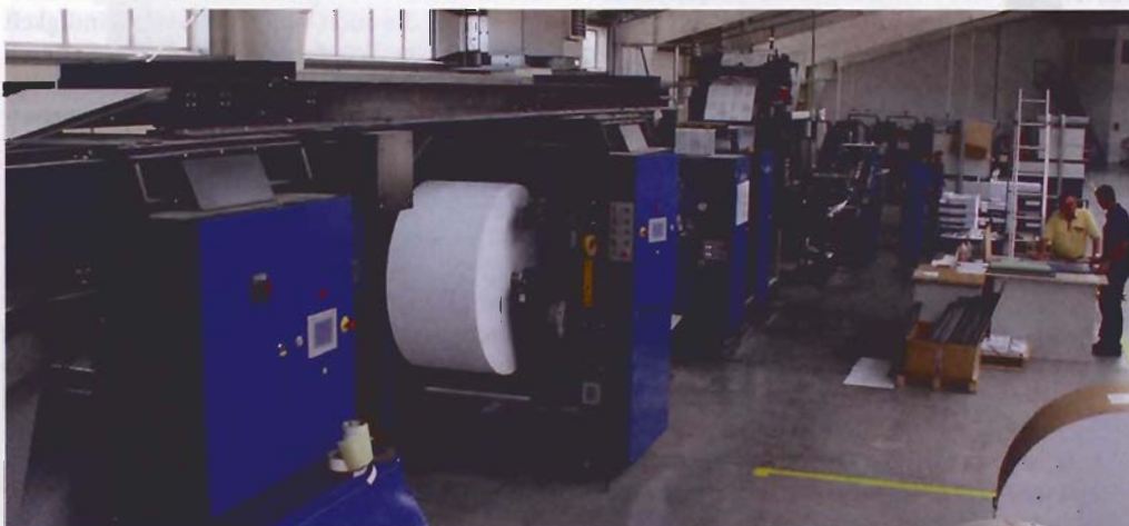
Mit der Einführung der Rollenproduktion mit der Maschine Zirkon 6612 wurde vielen Forderungen von Tinta-Kunden Rechnung getragen. Die Zweierwerkmaschine kann bis zu 35 000 Exemplare/h verarbeiten.
